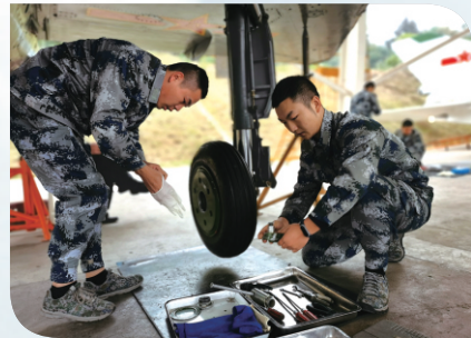
航空器起落架维护与修理培训
